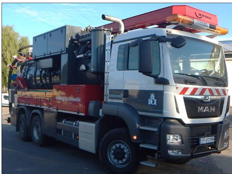
Ryc. 1. Specjalistyczny samochód ciśnieniowy z systemem odzysku wody
