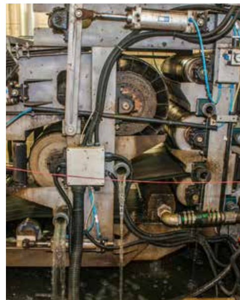
Prasa do odwadniania osadów ściekowych
