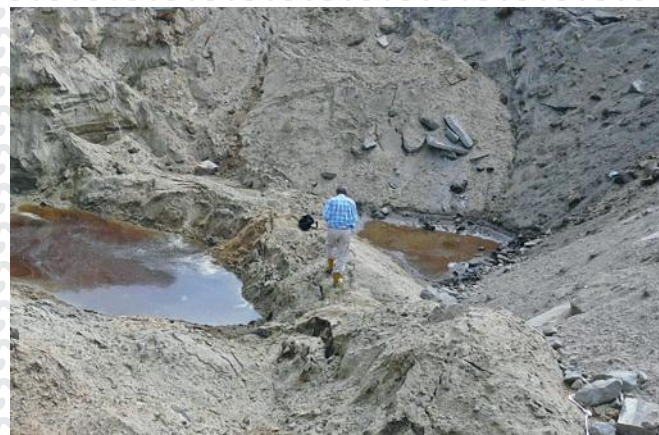
W wykopie celem oceny uwarunkowań geologicznych i stanu zanieczyszczenia substancjami ropopochodnymi (Grudziądz).
