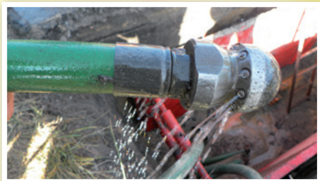
Dysze zastosowane przy czyszczeniu sieci wodociągowej - od lewej: rotacyjna i wyptukująca osad
