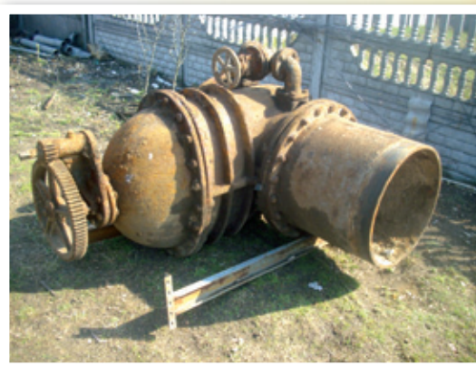
Zasuwa przed renowacją
